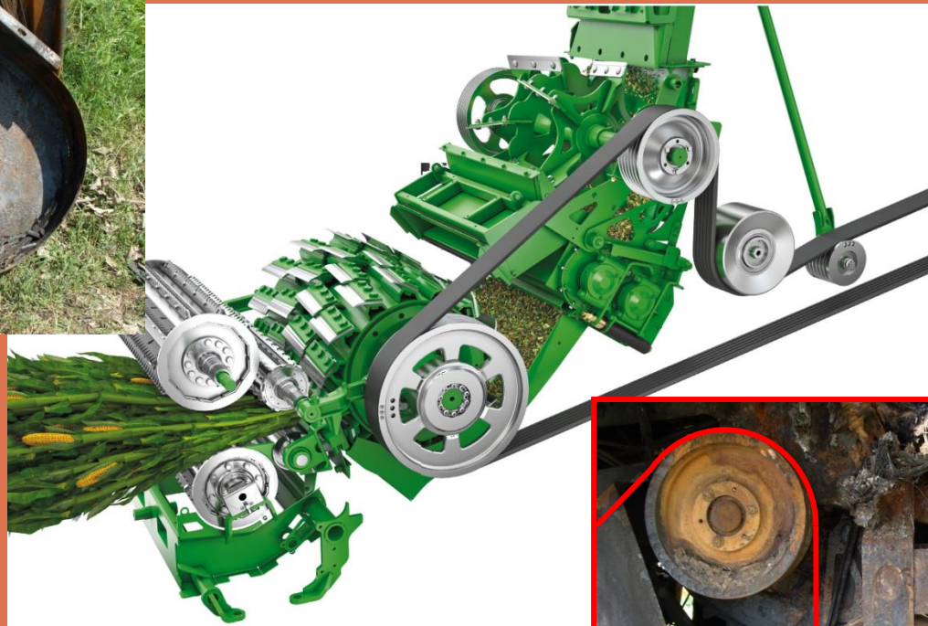
Kormozódás nyoma a meghajtó dobon
