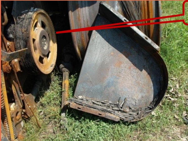
Kormozódás nyoma a meghajtó dobon
